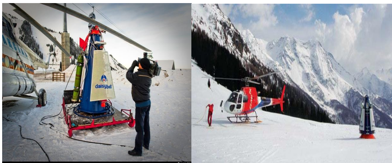
სურ.4.12-4.13. DAISYBEEL –ის ანუ „ზარის“ მეტალის კონუსი და მისი მიმაგრება შეეუღლმფრენზე
