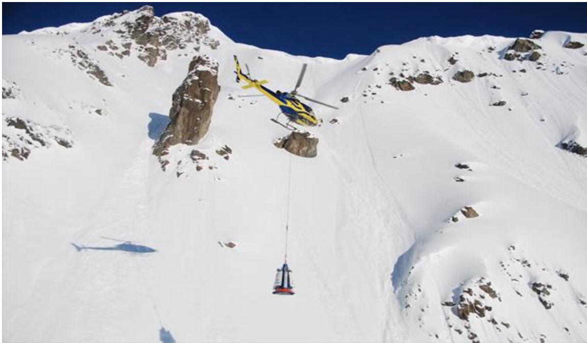
სურ. 4.14 ზვავშემკრებზე DAISYBEEL სისტემით ზემოქმედება
