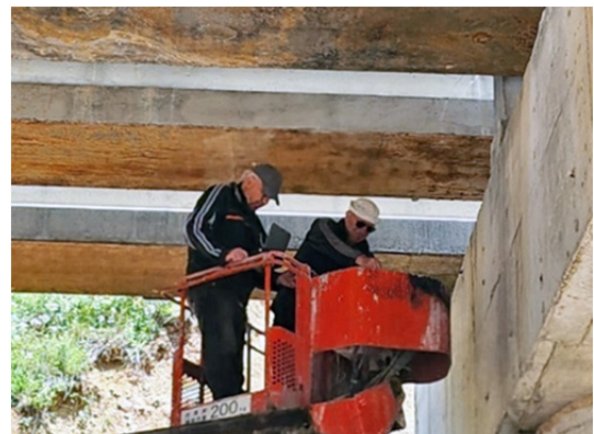
ნახ. 1. სიჩქარის გაზომვის პროცესი რკინაბეტონის კონსტრუქციაში
