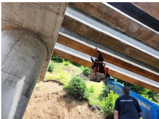
ნახ. 1. სიჩქარის გაზომვის პროცესი რკინაბეტონის კონსტრუქციაში
