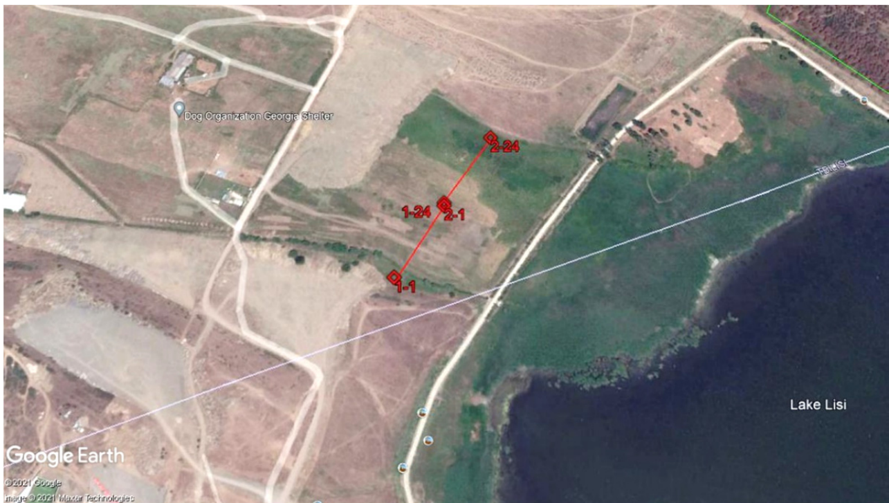
ნახ. 1. საკვლევი უბანი და სეისმური პროფილების განლაგების სქემა. №1 მიუთითებს პირველ გეოფონს ანუ პროფილის დასაწყისს, ხოლო №24 – 24-ე გეოფონს ანუ პროფილის ბოლოს.
