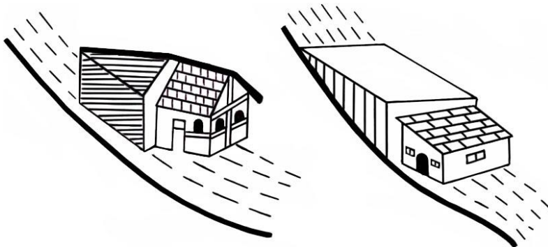
ნახ. 6.3. შესაბამისი კონსტრუქციებით საცხოვრებელი სახლების დაცვა ზვავებისაგან
