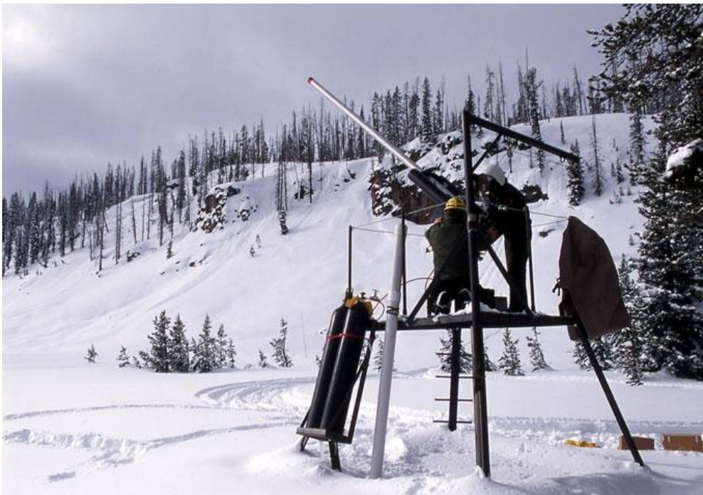
ნახ. 6.13. პნევმატური ქვემეხი AVALAUNCHE
