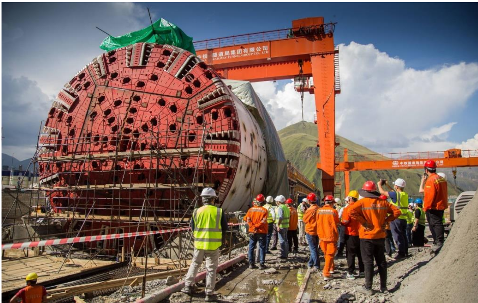
ნახ. 1.3.9. გვირაბის მშენებლობისთვის გამოყენებული ბურღი ( https://kveshetikobiroad.ge/ )
