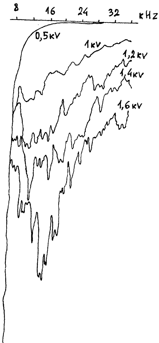
Рис.5 Экспериментальные записи спектров ЭМИ для песчаника.
