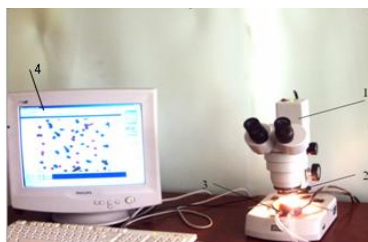
Рис.6. Аппаратура для регистрации ледяных кристаллов. 1– оптический микроскоп, 2 – видеокамера, 3 – термостол, 4- персональный компьютер.
