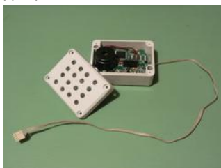
Рис.3. Встраиваемая в ПУ «Элия-2» метеостанция для измерения температуры, влажности и давления воздуха.
