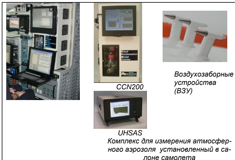
Рис.1. Состав микрофизического комплекса для измерения атмосферного аэрозоля.
