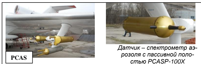
Рис.2. Датчик – спектрометр аэрозоля с пассивной полостью PCASP-100X, установленный на пилоне под крылом самолета.
