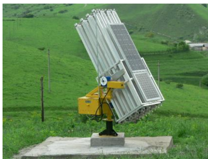
Рис. 1. Автоматическая противоградовая установка ПУ "Элия-2".
