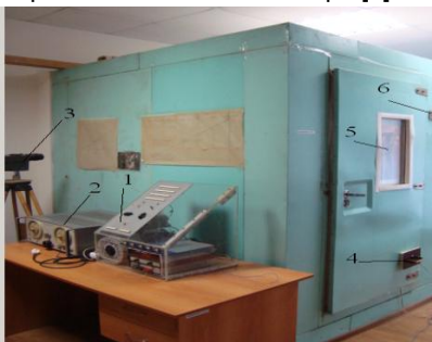
Рис.1. Большая облачная камера. 1—пульт управления; 2—генератор низких частот; 3—тепловизор; 4—окошко для доступа в камеру во время проведения экспериментов; 5—смотровое окно; 6— система регулировки температуры.
