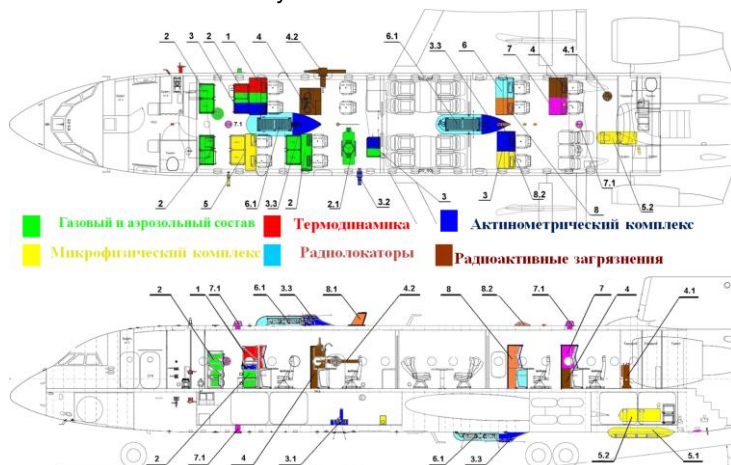
Рис.2. Общая схема размещения научного оборудования на борту самолета-лаборатории Як-42Д «Росгидромет».
