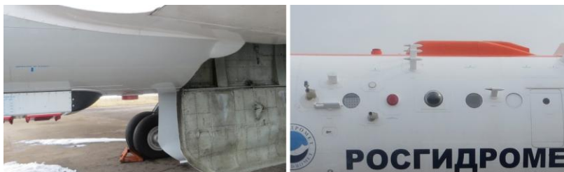
Рис.3. Размещение датчиков СПНП и других обтекателей и антенн.
