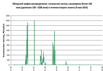
Рис.9. Примеры измерения водности облаков и облачных частиц размерами более 100 мкм.
