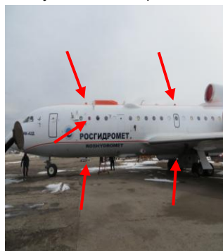
Рис. 2. Размещение датчиков СПНП на фюзеляже Як-42 «Росгидромет».
