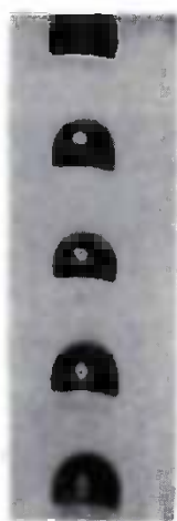
Рис. 4.10. Сближение падающей водяной капли размером 2 мм с заряженной ледяной поверхностью
