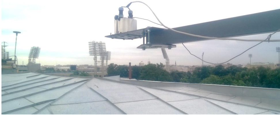
Рис. 1. Измеритель напряженности электрического поля «Рябина».
