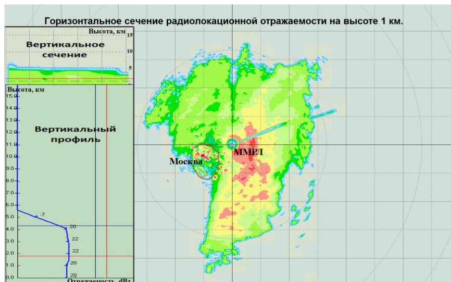
Рис. 2. Цифрокарта с отображением горизонтального (на высоте H = 1 км) и вертикального сечений, и вертикального профиля радиолокационной отражаемости слоистообразной облачности, в 03:18, 05 мая 2014 года.
