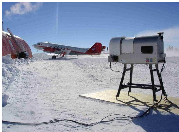
Рис. 3. Внешний вид СВЧ-радиометра RPG-HATPRO.
