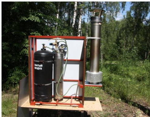
Рис. 1. Наземный аэрозольный ацетоновый генератор НАГ-07А.
