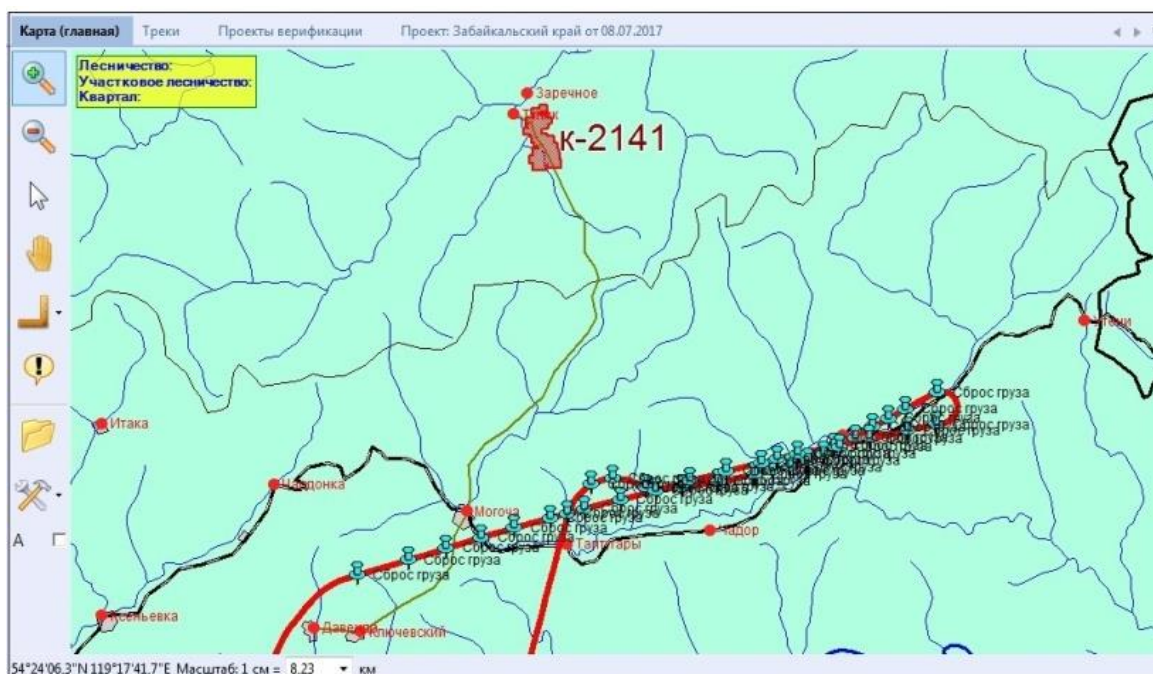
Рис.1. Траектория полета самолета Ан-26 «Циклон» с воздействиями 8 июля 2017 г. (пожар к-2141 в районе поселка Турик).
