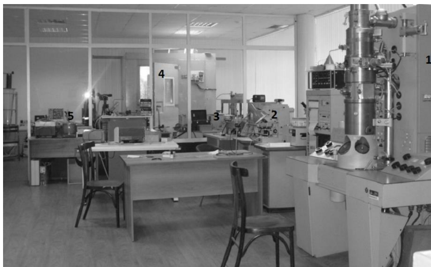
Рис. 1. Комплекс лабораторной аппаратуры, где проводился синтез нанотрубок оксида цинка: 1 – электронный микроскоп ЭММА-4, 2 – оптический микроскоп МБИ-15, 3 – вакуумная установка, 4 – большая облачная камера, 5 – оптический микроскоп Motic.
