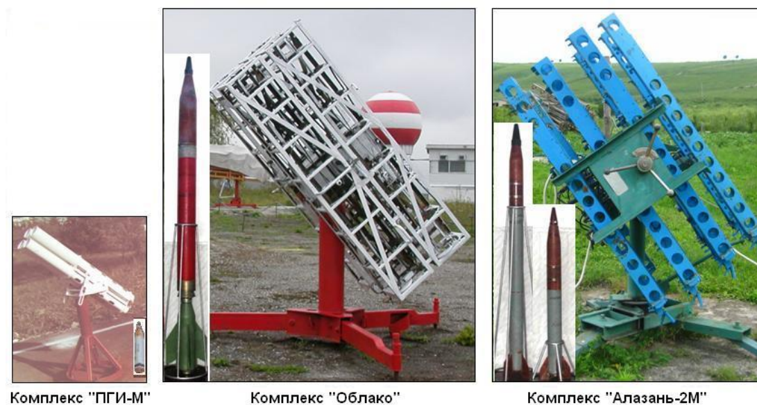
Рис. 3. Ракетные противорадовые комплексы первого поколения.
